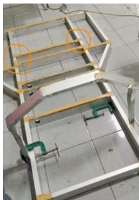
Gambar 4. Sambungan chassis menggunakan kombinasi paku keling dan lem epoxy (lingkaran) [5].
